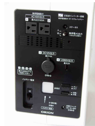
操作パネル部分。AC100V出力が 2つ、シガーライターソケットや USB端子も備える
